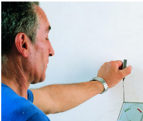
Verificarea umidității din tencuiala pe baza de ipsos
